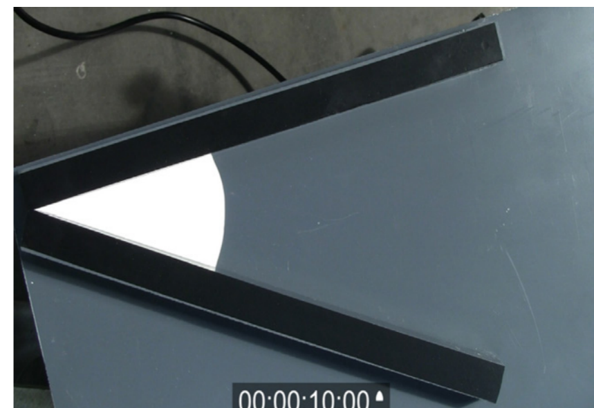
figura 2. Sospensione di amido di mais in acqua: propagazione della corrente su di un piano in condizioni di simmetria assiale (per semplicità l'esperimento è stato condotto su un settore circolare con ampiezza limitata). L'immissione avviene al centro del settore, tramite un foro praticato nel pannello in PVC.
